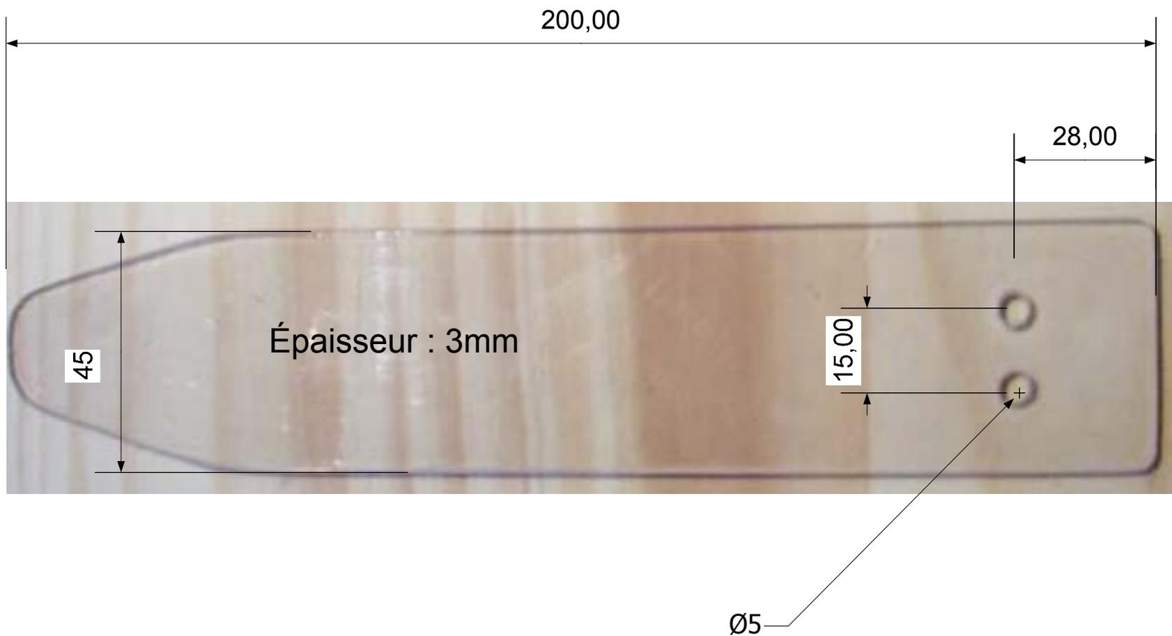
Support papier en lexan à fixer derrière le rétro
